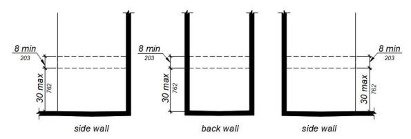
FIGURE 11B-809.10.6.4 REINFORCEMENT FOR GRAB BARS.
